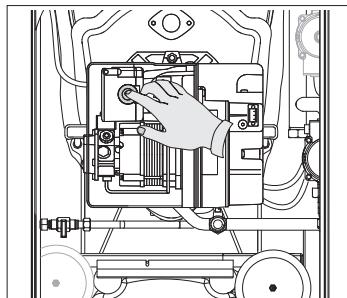
**⚠️** Après un "ARRET DE BLOCAGE" attendre environ secondes avant de rétablir les conditions de mise en marche.
