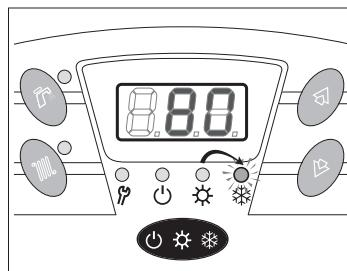
**⚠** Per il modello **THE/CI B/G2** in regime invernale sono abilitate entrambe le zone. Per l'esclusione di una delle due agire sul selettore di funzione del pannello di comando portandolo nella posizione "Ⓐ" (attiva solo la zona 1) o "Ⓑ" (attiva solo la zona 2).
